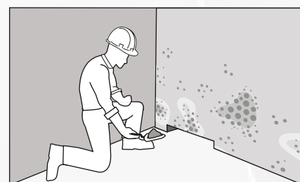
3 Preencha todo o espaço rompido com a Massa para Reboco e Rodapé.
