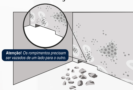
2 Rompa o reboco e tijolos acima do baldrame o mínimo possível ( mínimo 4 cm e máximo 6 cm ), intercalando em espaços de 1 metro de comprimento.
